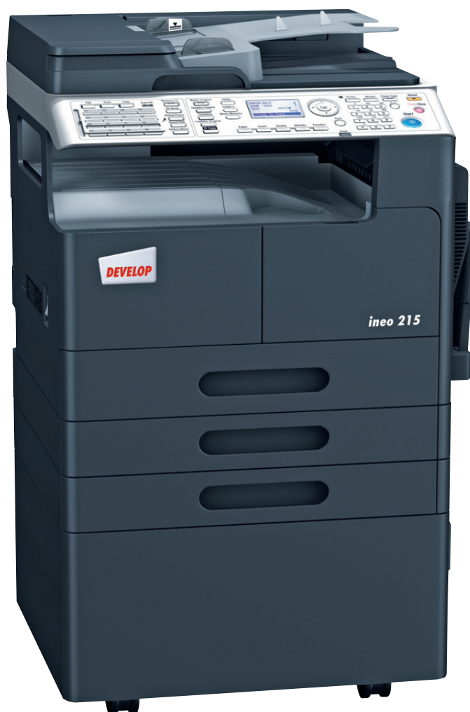
ineo 215 mit automatischem Dokumenteneinzug, Faxfunktion, Duplexeinheit, Multi-Bypass, zusätzlichen Papierkassetten (2 x 250 Blatt) und mittelgroßem Unterschrank
